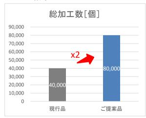
・砥石形状崩れにより平行度悪化。 砥粒、粒度、結合度の見直しを したことで砥石寿命が2倍となった。
